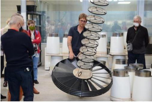
Les jeunes huîtres sont ensuite transférées sur le site Grainocéan du port de La Pallice où elles sont disposées sur des lanternes, assemblage de tamis circulaires superposés et gainés par un filet. Chaque lanterne à la base de laquelle est fixée une hydrolienne est ensuite totalement immergées en pleine mer. Ce système ingénieux mis au point par la société, présente ainsi l'avantage de se mettre en rotation lors des marées.
